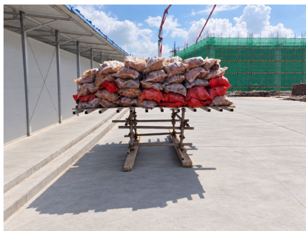
图1 旋转扣件搭接立杆堆载试验
