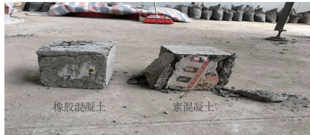
图1 橡胶混凝土与素混凝土破坏形态对比
