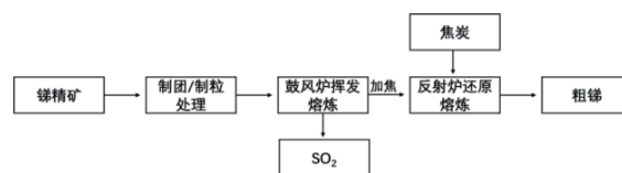
图1. 鼓风炉挥发—反射炉还原工艺流程图
