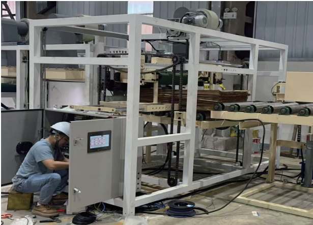
图2 第二代木材单板上板机的试验
