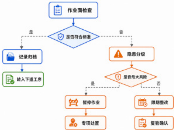
图2 施工阶段检查与整改分支
