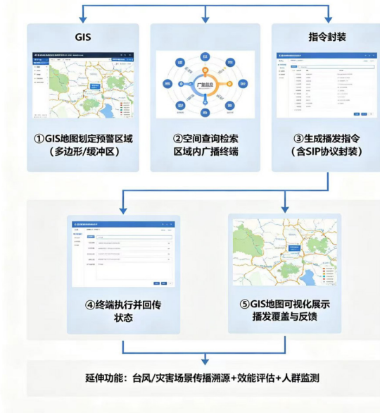
图2：应急广播与GIS联动定位播发流程图
