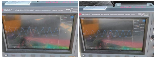
图8 下行滤波器输入输出波形
