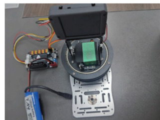
图5 系统整体样机实物图
