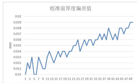
图7 校准前实测厚度与标准块厚度偏差值
