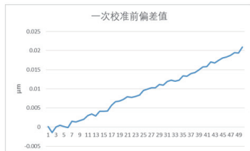
图5 光栅尺校准前与激光干涉仪偏差值
