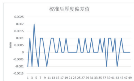
图8 校准后实测厚度与标准块厚度偏差值
