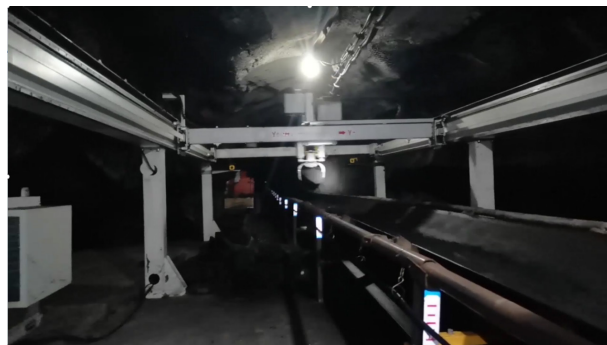
图3.1 异物分拣机器人现场应用
