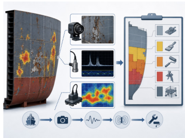
图2 多源检测结果转换为维修派工示意
