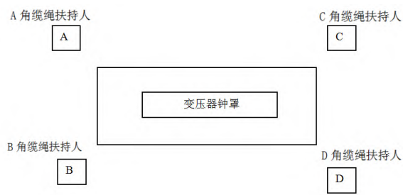
图2 变压器起吊油箱示意图
