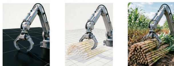
图2 MoveIt2 中的机械臂手建模与整杆甘蔗抓取仿真
