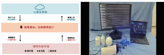
图 2：系统硬件拓扑与实物实拍图
