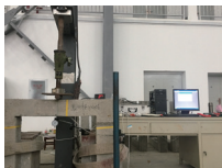
图3 门型框架梁加载及测点布置现场图
