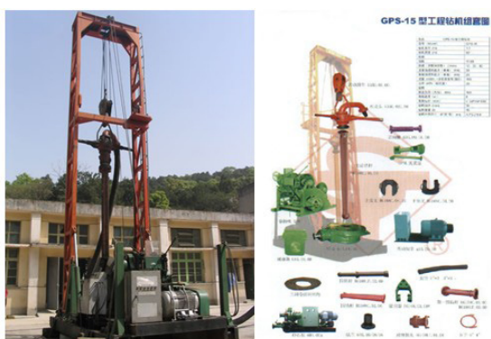
图1 GPS—15正循环钻机示意图
