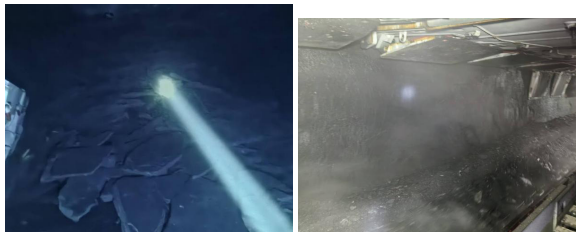
图1-2 采空区直接顶开始出现垮落现象
