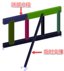
图11 分段桁架临时支撑图
