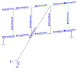
图12 分段桁架计算模型
