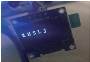
图 3 可回收垃圾在 OLED 显示的结果
