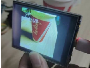
图4可回收垃圾在检测成功后在 k210上显示的结果
