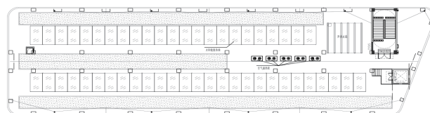
图3 屋顶太阳能集热板布置示意图
