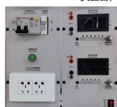
图8-1 总电源模块及直流电压表、电流表模块
