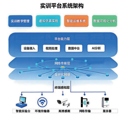
图1 电子电工实训室智慧化系统架构图
