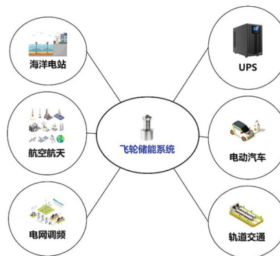
图 1: MW 级飞轮储能典型应用场景
