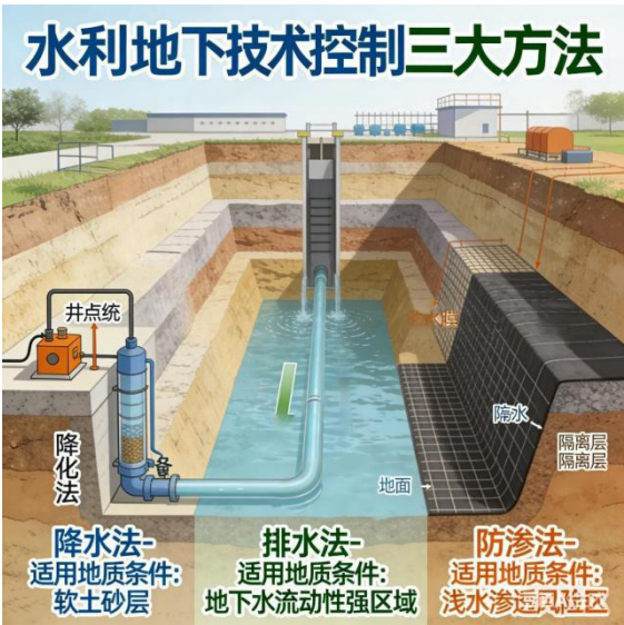
图1 地下水控制方法
