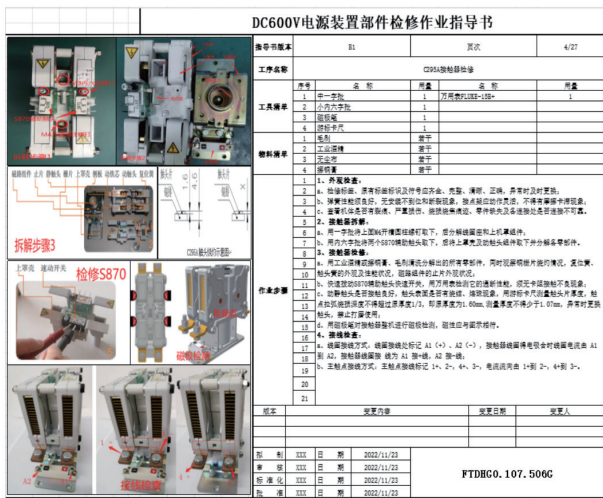
图3 车载电源系统接触器检修标准化作业
