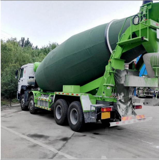
图2 混凝土保温罐车及运输保温措施
