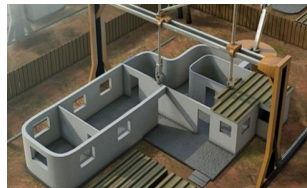
图2 轮廓工艺打印的工作原理
