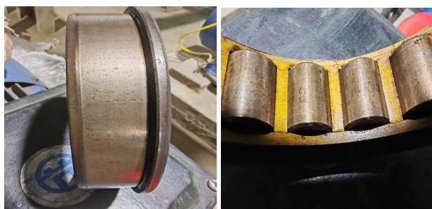
图3 罗茨泵轴承腐蚀磨损严重
