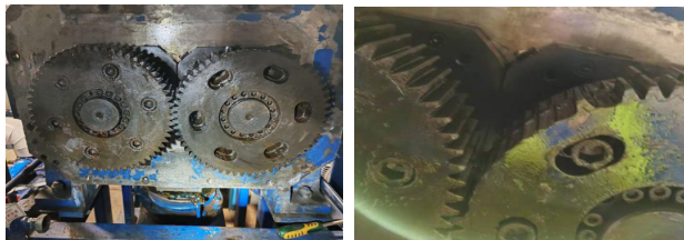
图1 气冷罗茨泵从动齿轮损坏图片
