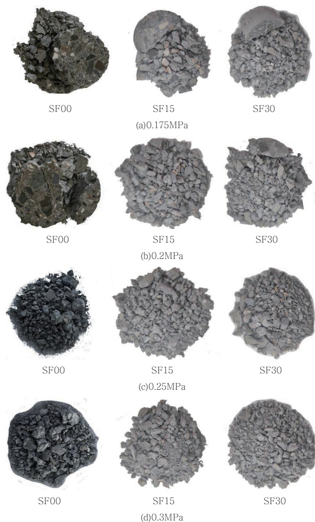
> 图3 相同冲击气压下各腐蚀试件的破坏形态
