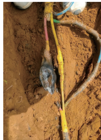
> 图1：施工质量问题导致集电线路故障的现场剖析图
