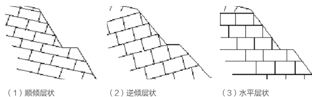
> 图1 边坡地层倾向示意图
