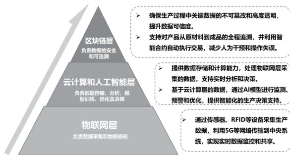
> 图1 智能制造全流程管控系统技术架构图
