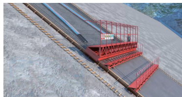
图1 面板混凝土施工示意图
