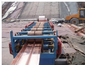
图2 止水铜片加工图
