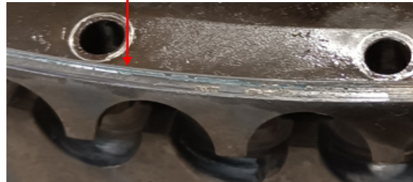
> 图6 VSV内罩环前缘磨损状态
