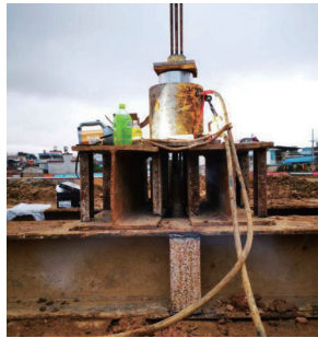
> 图12 复合锚杆基本试验
