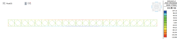
> 图4.4 组合施工荷载后贝雷梁应力图（单位：MPa）
