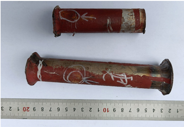
> 图 1 泄漏接管外壁
