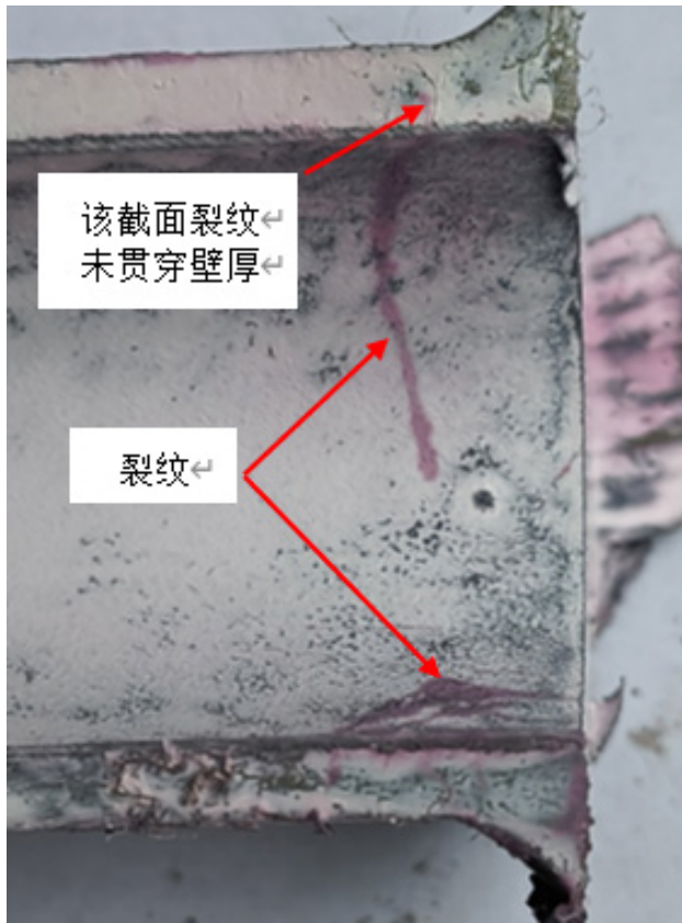
> 图2管道泄漏处着色探伤
