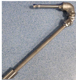
> 图3 定制的组合式保护套管
