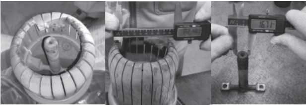
>图1 静触头下触指4片触指被撞击后向内弯曲
