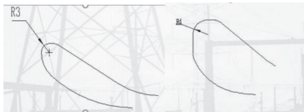
>图8 调整后的静触头触指端部外形局部结构
