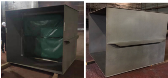
图1 水性漆喷涂测试工装
