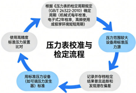
图1 压力表定期校准与检定流程图
