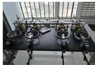
图1 室内四联直剪仪
