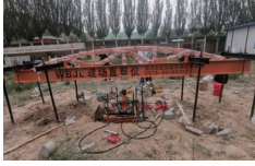
图3 现场大型直剪实验实训现场 图4 大型直剪实验原理示意图
