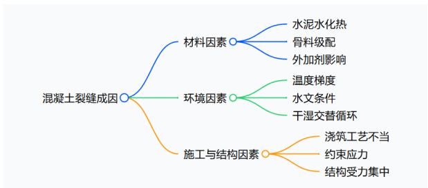
图1 混凝土裂缝成因分类示意图
