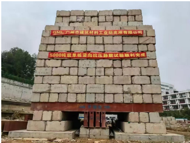
图2 单桩竖向抗压静载试验图
