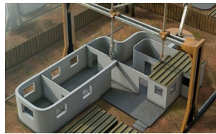
图2 轮廓工艺打印的工作原理
