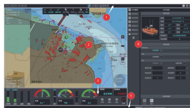
图 3-3 无人船显控软件界面示意图
