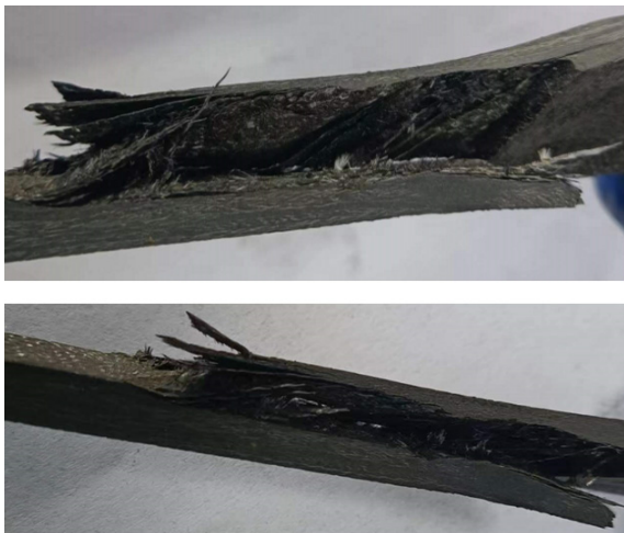
图4 测试后的拉伸试样（碳纤维预浸带制备的井盖）
