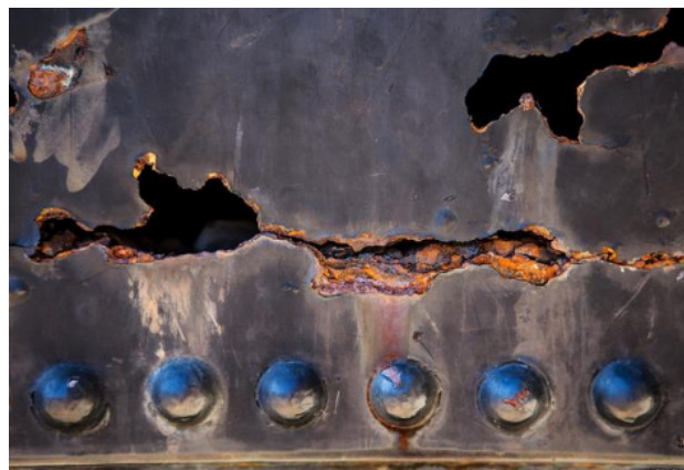
图2 应力腐蚀裂纹
