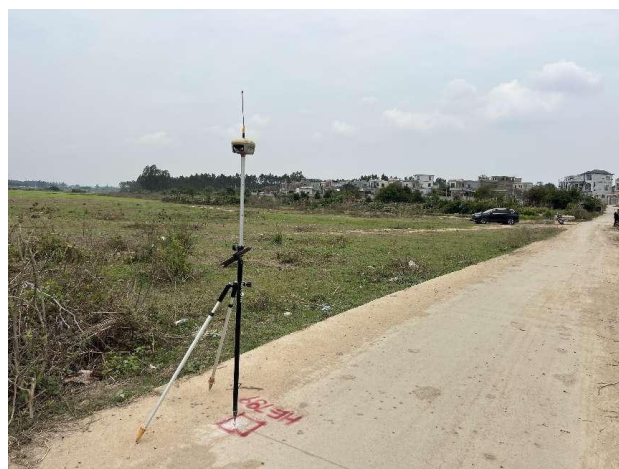
图3 基础控制点采集
