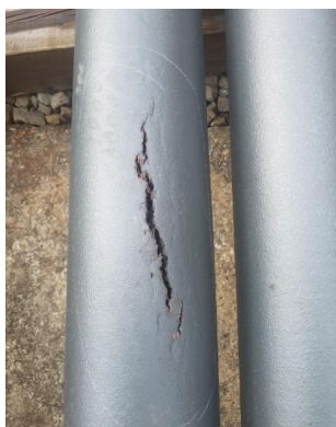
图1 炉管蠕变裂纹
