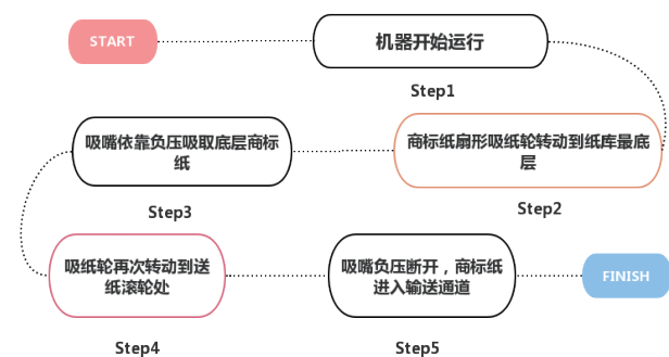
> 图1 商标纸输送流程图
