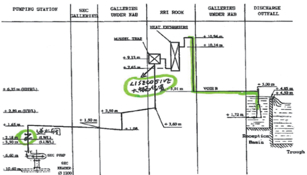
> 图3 L1SEC A列管道布置图 [4]
