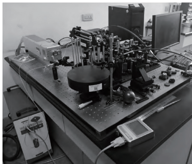
> 图2实验室 LIBS 装置实物图
